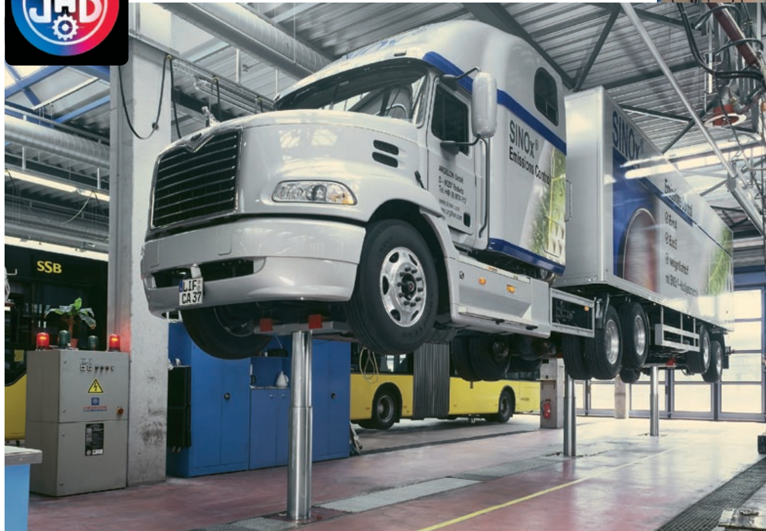
Arriba y a la derecha : elevador de 3 pistones tipo HVD, capacidad de elevación 14.000 kg por cilindro, altura de elevación 1.900 mm.
